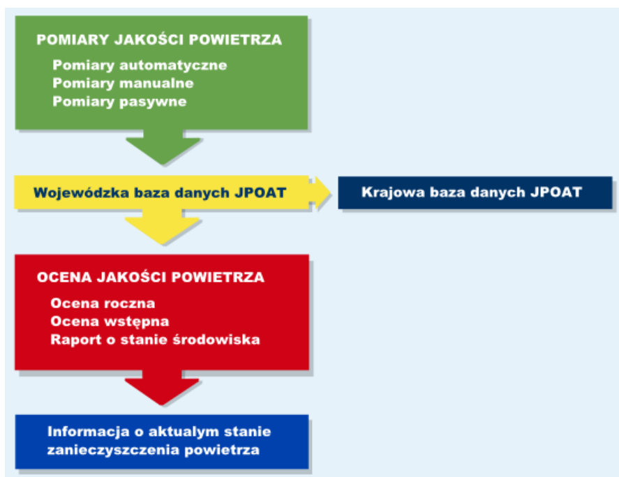
Rysunek 3.6 Schemat funkcjonowaniu monitoringu ochrony powietrza
