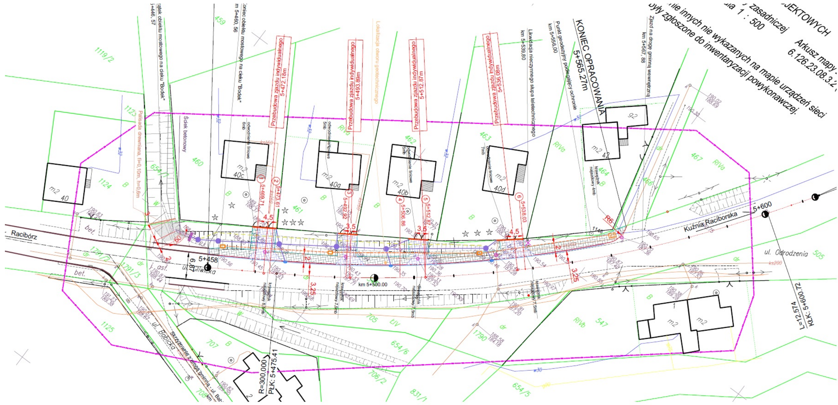
Załącznik nr 7. Budowa chodnika w ciągu DW 919 ulicy Gliwickiej na odcinku od cieku Bodek do drogi gminnej.
