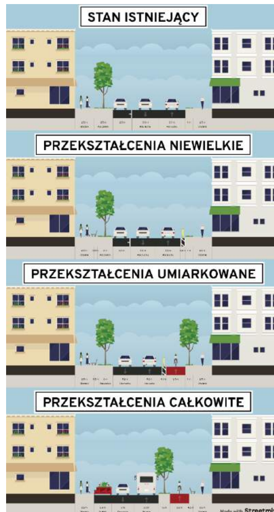
Rysunek 6.9 Przykładowe zmiany w przekrojach ulic
